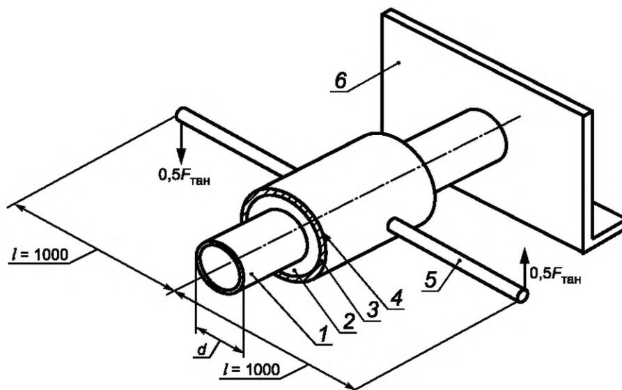
1 — стальная труба; 2 — ППУ изоляция; 3 — защитная оболочка; 4 — хомут; 5 — рычаг; 6 — неподвижная опора;
