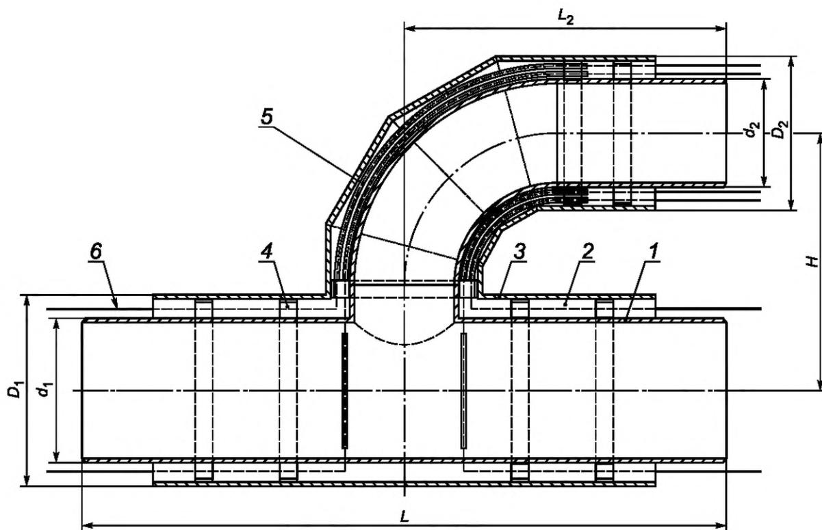
1 — параллельный стальной тройник; 2 — ППУ изоляция; 3 — защитная оболочка; 4 — центрирующая опора; 5 — электроизоляционная перфорированная трубка; 6 — проводник-индикатор СОДК (показан условно);  $D_1$  — наружный диаметр защитной оболочки основания;  $D_2$  — наружный диаметр защитной оболочки;  $d_1$  — наружный диаметр стальной трубы основания;  $d_2$  — наружный диаметр стальной трубы ответвления;  $H$  — высота ответвления;  $L$  — длина основания тройника;  $L_2$  — длина ответвления
