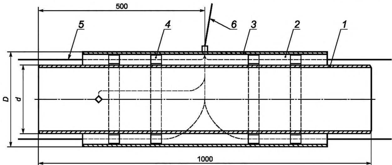
1 — стальная труба; 2 — ППУ изоляция; 3 — защитная оболочка; 4 — центрирующая опора; 5 — проводник-индикатор СОДК; 6 — кабельный вывод;  $D$  — наружный диаметр защитной оболочки;  $d$  — наружный диаметр стальной трубы
