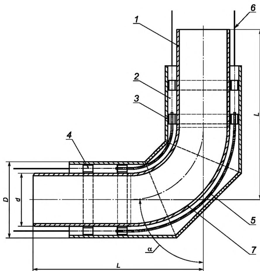
1 — стальной патрубок; 2 — ППУ изоляция; 3 — защитная оболочка; 4 — центрирующая опора; 5 — электроизоляционная перфорированная трубка; 6 — проводник-индикатор СОДК (показан условно); 7 — стальной отвод;  $D$  — наружный диаметр защитной оболочки;  $d$  — наружный диаметр стальной трубы;  $L$  — длина плеча отвода;  $\alpha$  — угол отвода
