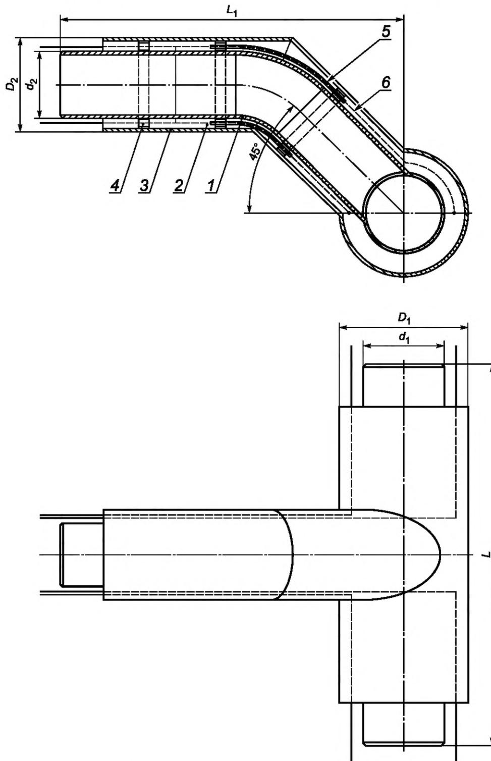
1 — стальное тройниковое ответвление; 2 — ППУ изоляция; 3 — защитная оболочка; 4 — центрирующая опора; 5 — электроизоляционная перфорированная трубка; 6 — проводник-индикатор СОДК;  $D_1$  — наружный диаметр защитной оболочки основания;  $D_2$  — наружный диаметр защитной оболочки ответвления;  $d_1$  — наружный диаметр стальной трубы основания;  $d_2$  — наружный диаметр стальной трубы ответвления;  $L$  — длина основания тройникового ответвления;  $L_1$  — длина тройникового ответвления
