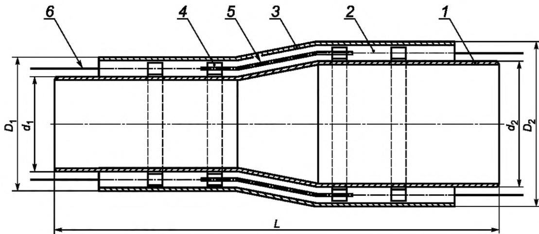
1 — стальная труба; 2 — ППУ изоляция; 3 — защитная оболочка; 4 — центрирующая опора; 5 — электроизоляционная перфорированная трубка; 6 — проводник-индикатор СОДК (показан условно);  $D_1$  — меньший наружный диаметр защитной оболочки перехода;  $D_2$  — больший наружный диаметр защитной оболочки перехода;  $d_1$  — меньший наружный диаметр стальной трубы перехода;  $d_2$  — больший наружный диаметр стальной трубы перехода;  $L$  — длина перехода
