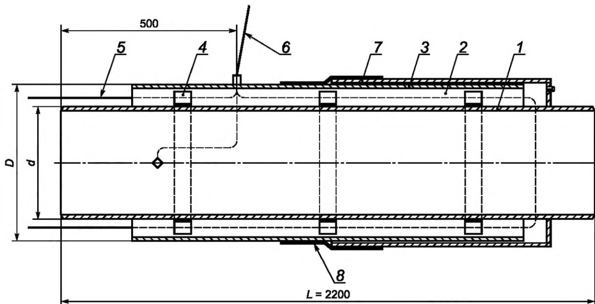
1 — стальная труба; 2 — ППУ изоляция; 3 — защитная оболочка; 4 — центрирующая опора; 5 — проводник-индикатор СОДК; 6 — кабельный вывод; 7 — металлическая заглушка изоляции; 8 — гидроизоляция металлической заглушки изоляции;  $D$  — наружный диаметр защитной оболочки;  $d$  — наружный диаметр стальной трубы;  $L$  — длина концевой элемента
