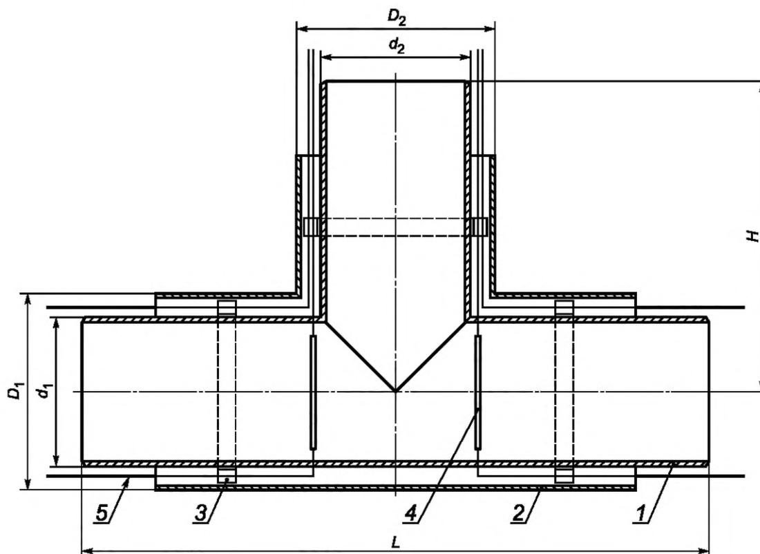
1 — стальной тройник; 2 — ППУ изоляция; 3 — центрирующая опора; 4 — электроизоляционная перфорированная трубка; 5 — проводник-индикатор СОДК;  $D_1$  — наружный диаметр защитной оболочки основания;  $D_2$  — наружный диаметр защитной оболочки ответвления;  $d_1$  — наружный диаметр стальной трубы основания;  $d_2$  — наружный диаметр стальной трубы ответвления;  $H$  — длина ответвления;  $L$  — длина тройника
