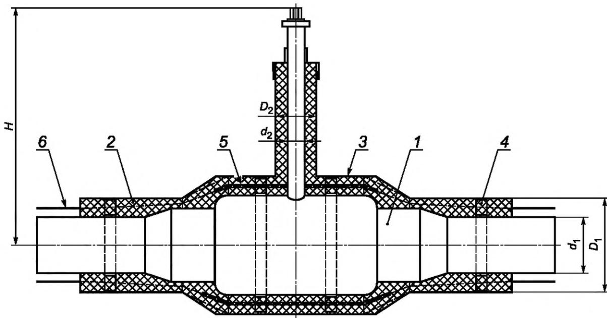
1 — шаровой кран; 2 — ППУ изоляция; 3 — защитная оболочка; 4 — центрирующая опора; 5 — электроизоляционная перфорированная трубка; 6 — проводник-индикатор СОДК (показан условно);  $D_1$  — наружный диаметр защитной оболочки изолированного крана;  $D_2$  — наружный диаметр защитной оболочки штока;  $d_1$  — наружный диаметр стального патрубка крана;  $d_2$  — наружный диаметр штока;  $H$  — высота крана
