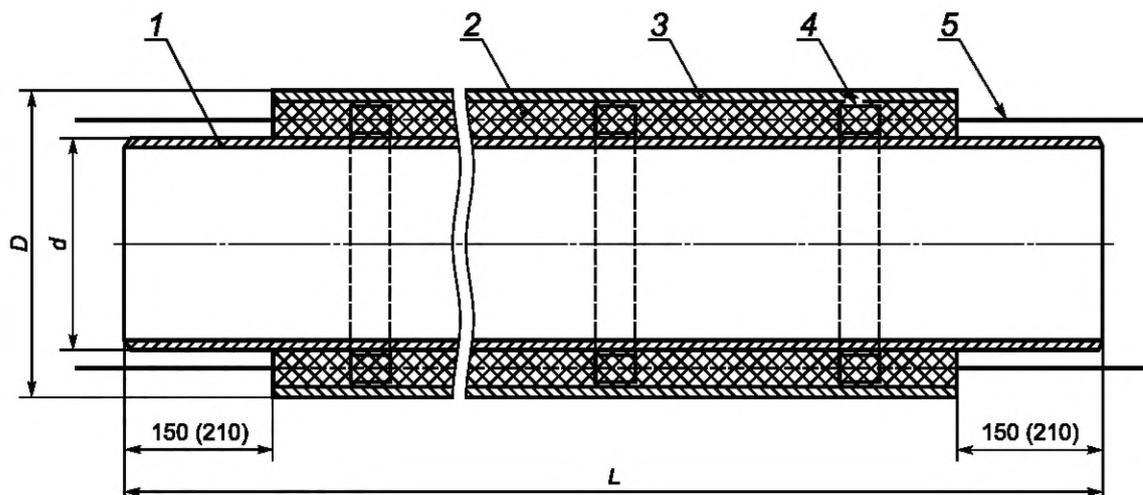
1 — стальная труба; 2 — ППУ изоляция; 3 — защитная оболочка; 4 — центрирующая опора;
