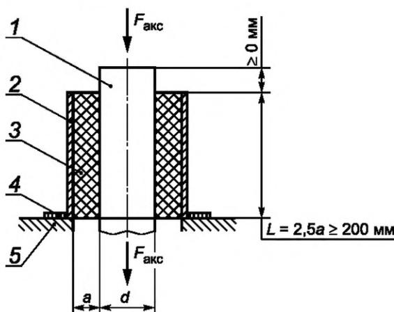
1 — стальная труба; 2 — защитная оболочка; 3 — ППУ изоляция; 4 — направляющее кольцо; 5 — плита основания машины для испытания;  $a$  — толщина изоляции;  $F_{акс}$  — прилагаемая нагрузка (внизу — альтернативный способ приложения нагрузки);  $d$  — см. экспликацию к формуле (4)
