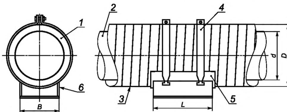
1 — ППУ изоляция; 2 — стальная труба; 3 — защитная оболочка; 4 — крепящие хомуты; 5 — резиновая прокладка; 6 — скользящая опора;  $B$  — ширина основания скользящей опоры;  $D$  — наружный диаметр защитной оболочки;  $d$  — наружный диаметр стальной трубы;  $L$  — длина скользящей опоры
