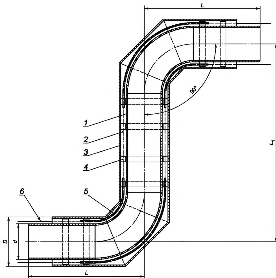
1 — стальная труба; 2 — ППУ изоляция; 3 — защитная оболочка; 4 — центрирующая опора; 5 — электроизоляционная перфорированная трубка; 6 — проводник СОДК;  $D$  — наружный диаметр защитной оболочки;  $d$  — наружный диаметр стальной трубы;  $L$  — длина плеча Z-образного элемента;  $L_1$  — расстояние между осями Z-образного элемента
